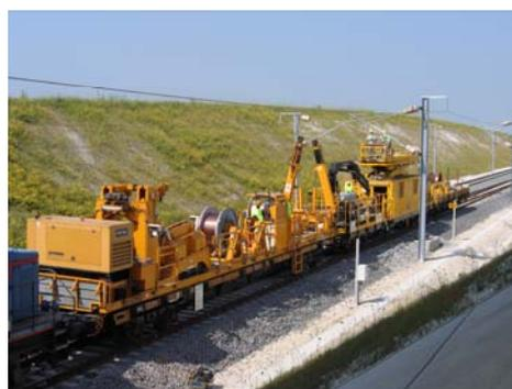
L'électricité est acheminée par des **caténaires**. Des **trains de travaux** permettent de réaliser et entretenir le réseau.
